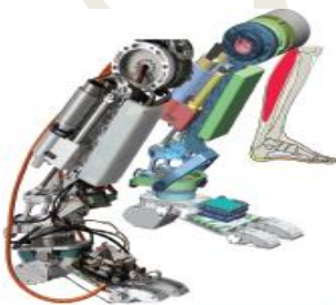
ساق الرجل الآلي مدعومة بالعضلات الهوائية
